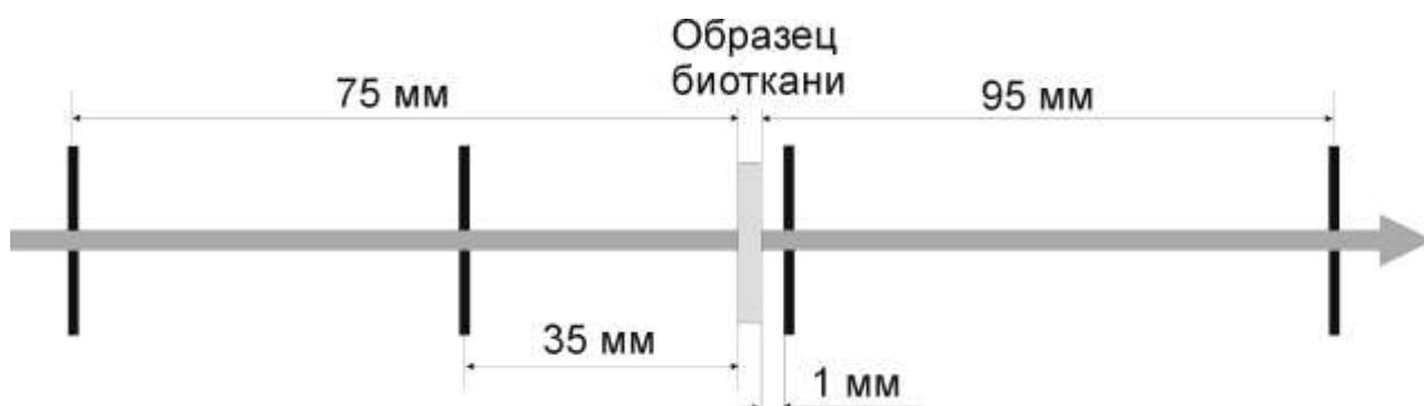
Рисунок. 2.3. Схема приставки для измерения коллимированного пропускания образцов биологической ткани.
