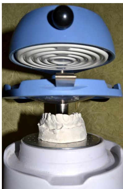
Рис. 45. Термовакуумное формирование каппы на miniStar.
