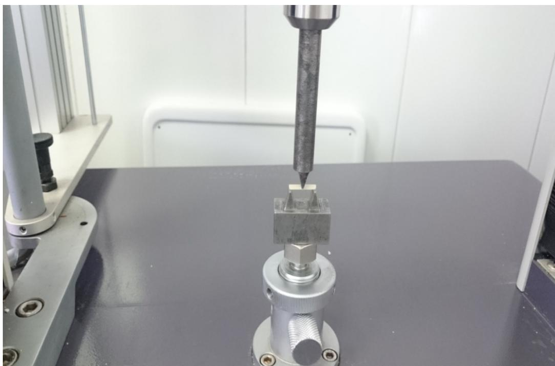
Рисунок 10. Процесс испытания образца керамического материала на прочность.
