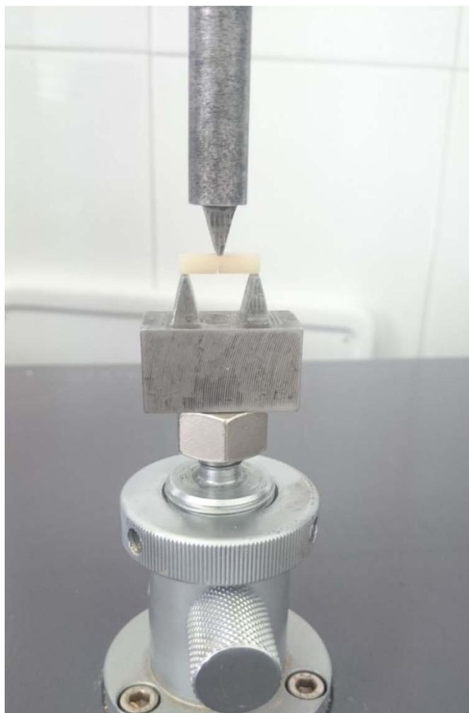
Рисунок 14. Процесс испытания образца керамического материала на вязкость разрушения.
