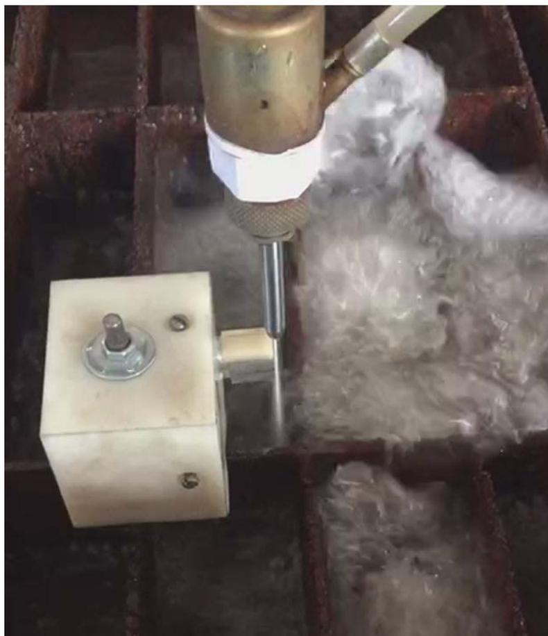
Рисунок 8. Процесс гидроабразивной резки керамического блока.
